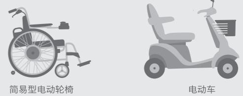
最高可跨越5cm的台阶 一般电动车的前轮无法跨越台阶。
